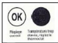
A chaque modification du réglage du thermostat, attendez la stabilisation de la température à l'intérieur de l'appareil avant de procéder si nécessaire à un nouveau réglage. Ne modifiez la position du thermostat que progressivement et attendez au moins 12 heures avant de procéder à une nouvelle vérification
