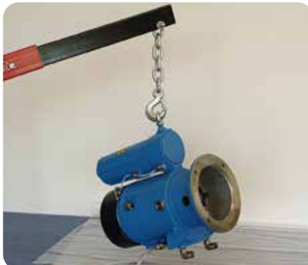
Als het restant olie uit het airend gelopen is kunt u deze (bijvoorbeeld met lift/takel) op de werkbank plaatsen.
