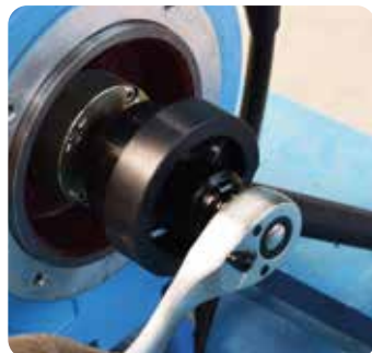
Om de kop te verwijderen dient u eerst de borgmoer (kroonmoer) te verwijderen. Hiervoor is een speciale dop nodig en borggereedschap. Draai vervolgens de moer los en verwijder deze.
