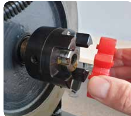
De flexibele koppeling kunt u van de as afnemen en vervangen.
