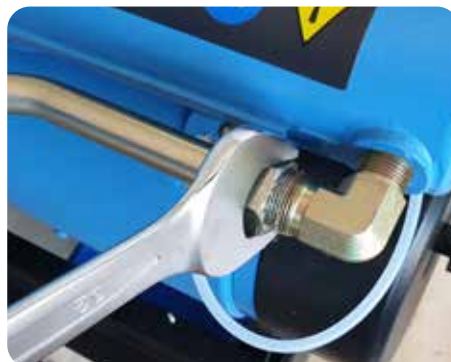
Demonteer de fitting van de olieleiding op het filterhuis. Sleutelmaat 18
