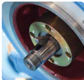
Verwijder de spie en de schroeven, demonteer vervolgens de behuizing met de oliekeerring.
