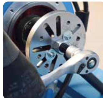
Verwijder de kop met een lagertrekker.
