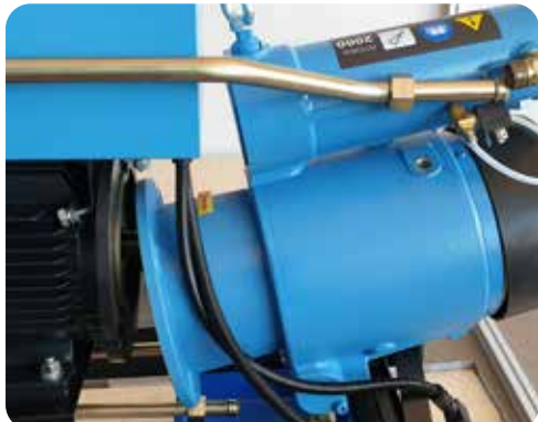
Schuif het airend van de motorzijde af. Er zal een aanzienlijke hoeveelheid olie uit de leiding komen, zorg dus voor een opvangbak.
