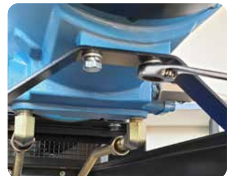
Verwijder beide bouten onder het compressorblok.
