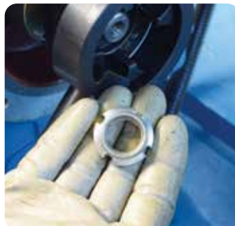
Om de kop te verwijderen dient u eerst de borgmoer (kroonmoer) te verwijderen. Hiervoor is een speciale dop nodig en borggereedschap. Draai vervolgens de moer los en verwijder deze.
