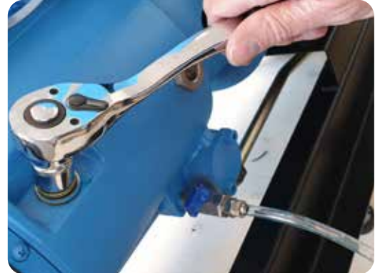
Maak de vuldop los, om zo het oliereservoir te beluchten.
