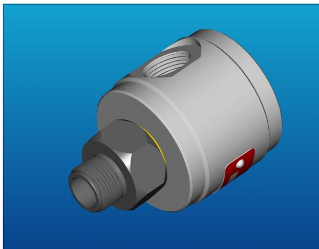
Giunto rotante per passaggio d'aria ed olio idraulico ad alta pressione. Il rotore, in acciaio al carbonio, è trattato per resistere all'usura e lappato per ridurre l'attrito. La tenuta è realizzata con guarnizioni a base di PTFE di disegno particolare. Il corpo esterno è ricavato da barra d'alluminio per eliminare qualsiasi possibilità di porosità; l'allineamento del gruppo è affidato a due bocche autolubrificanti in bronzo sinterizzato.
