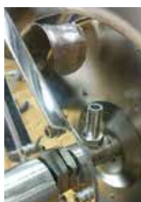
RVS slangpilaar voor aansluiting slang op haspel.
