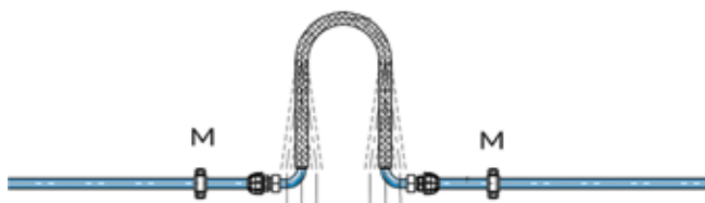
Expansielus, gebruik gemaakt van flexibele leiding
