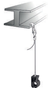
Cable hung pipe
